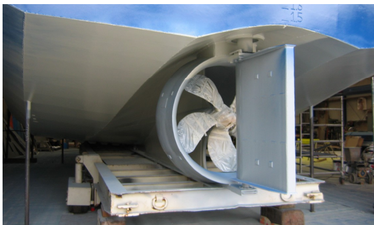
tunnel ter vergroting schroef
