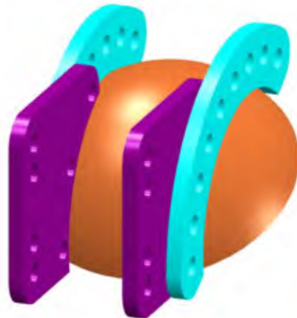
Figuur 3-15: Vijfde ontwerp HydroRig met zwaardere wangen (detail rechts) getest eind mei 2010 (Bron: K.J. Koffeman, schipper FD-281)
