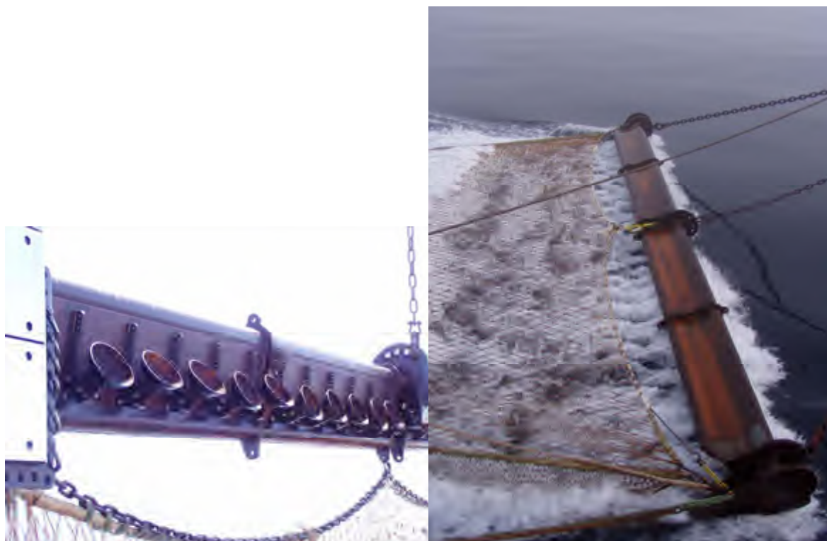
Figuur 3-12: Vierde versie HydroRig met bolkappen onder de vleugel uitgetest op de FD-281 in augustus 2009
