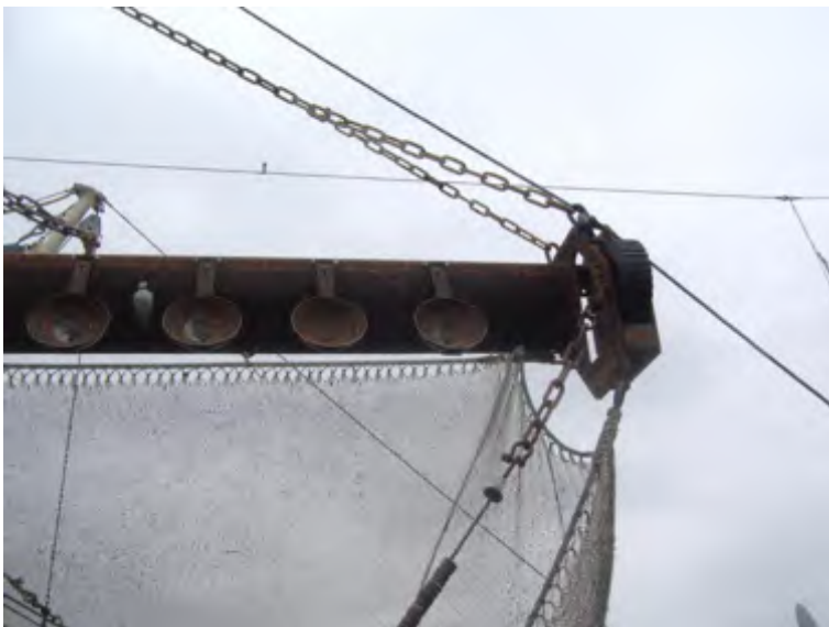
Figuur 1.1: Foto van de bolkoppen zoals in het veld getest
