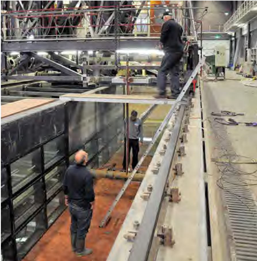
Figuur 3.2: Afstellen van het 1:1 schaal model in de goot
