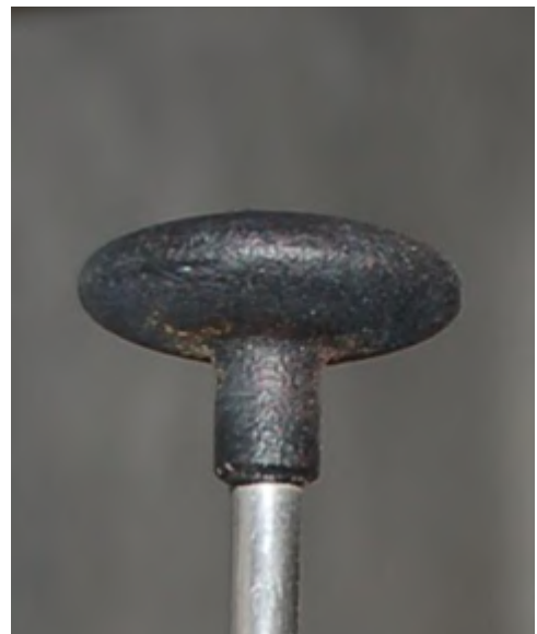
Figuur 6.1: Kop van een EMS sensor. De snelheidsmeting vindt plaats aan het oppervlak van de sensor
