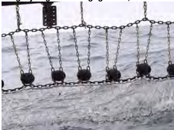
Figuur 4.1: Ophanging van de balkoppen achter de boom met kettingen
