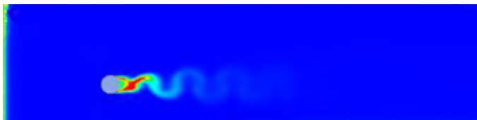
Figuur 4.2: TKE dissipatie achter de boom (modelberekening van de boom zonder balkoppen)
