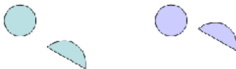
Figuur 1.1: Zijaanzicht van een naar links bewegende boom met bolkop. De figuur illustreert de positie van de bolkop t.o.v. de boom in originele configuratie (links) en configuratie waar de bolkop een deel van het zog van de boom invangt (rechts).
