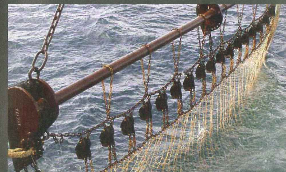
Versies van de hydrorig met een vleugelprofiel, balkoppen onder de vleugel en balkoppen aan de bovenpees tussen kettingen opgehangen.
