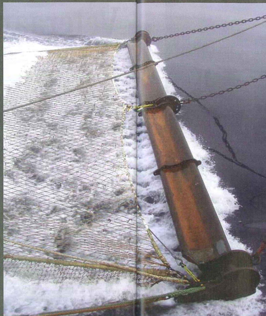
Versies van de hydrorig met een vleugelprofiel, balkoppen onder de vleugel en balkoppen aan de bovenpees tussen kettingen opgehangen.
