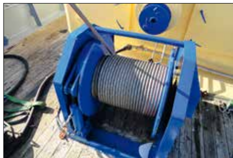
Dyneema-vislijn voor twinrigvisserij.
